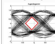
Bestimmung des Augendiagramm (4 Durchläufe): Für die Bereiche  $[-T_A, 0]$  und  $[0, T_A]$  werden die relevanten Pulse so überlagert (positiv oder negativ), dass das Auge minimal wird. Daraus ergibt sich die Überlagerungstabelle.
