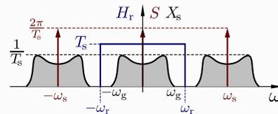
Bandbreite  $\omega_g$ , Abtastfrequenz  $\omega_s$
