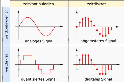
Vorteile digitales Signal: Kompression, Verschlüsselung, Fehlerkorrektur
