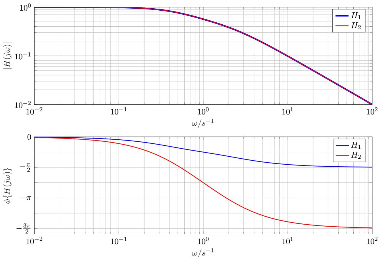
Die Phasenverschiebung ist also bei System 2 deutlich höher als bei System 1. Im Gegensatz zu System 2 gilt System 1 als minimalphasig. Daraus ergibt sich im maximalphasigen System 2 bei Anregung des Systems trotz des selben stationären Verhaltens (für  $t \rightarrow \infty$  ist der Ausgang der Systeme gleich) auch eine langsamere Reaktion, bzw. ein längeres Einschwingen. Für  $x(t) = u(t - 1)$  ergeben sich zum Beispiel folgende Ausgänge:
